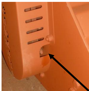
Schlegelwelle rechts und links 2-3 mal täglich gut abschmieren
