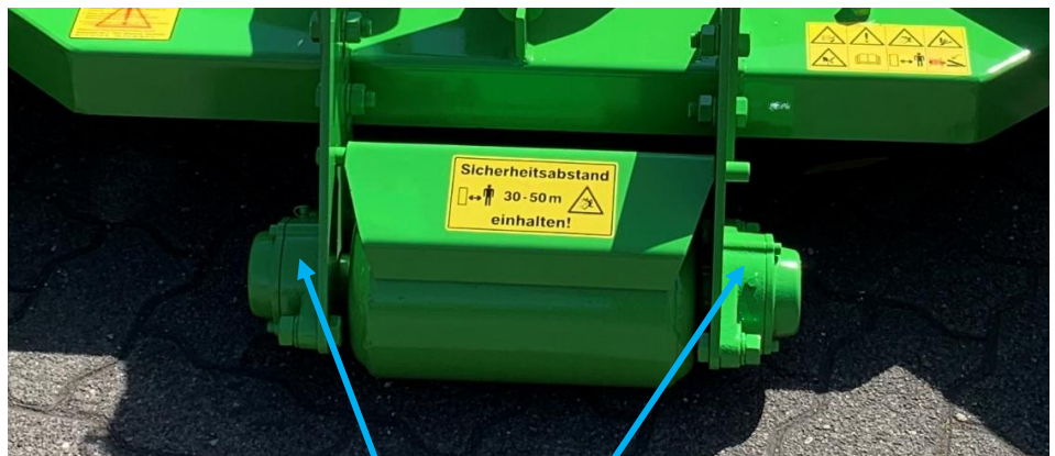
Laufwalze rechts und links 2-3 mal täglich abschmieren
