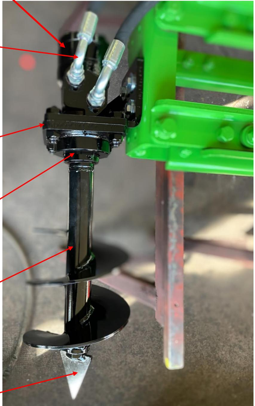
**Zum Wechseln des Bohrers müssen Sie die Madenschraube lösen, den Exzenterring nach links herum zum öffnen drehen und den Bohrer abziehen!**
