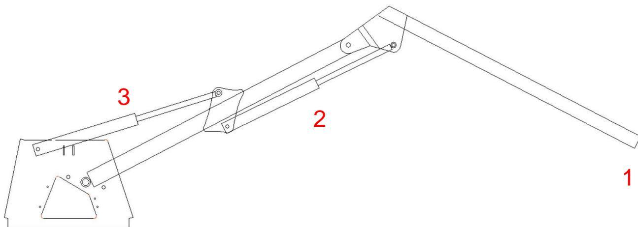
**1** = Hydraulikzylinder 400 mm Hub Kolbenstange  $\varnothing$  30 mm
