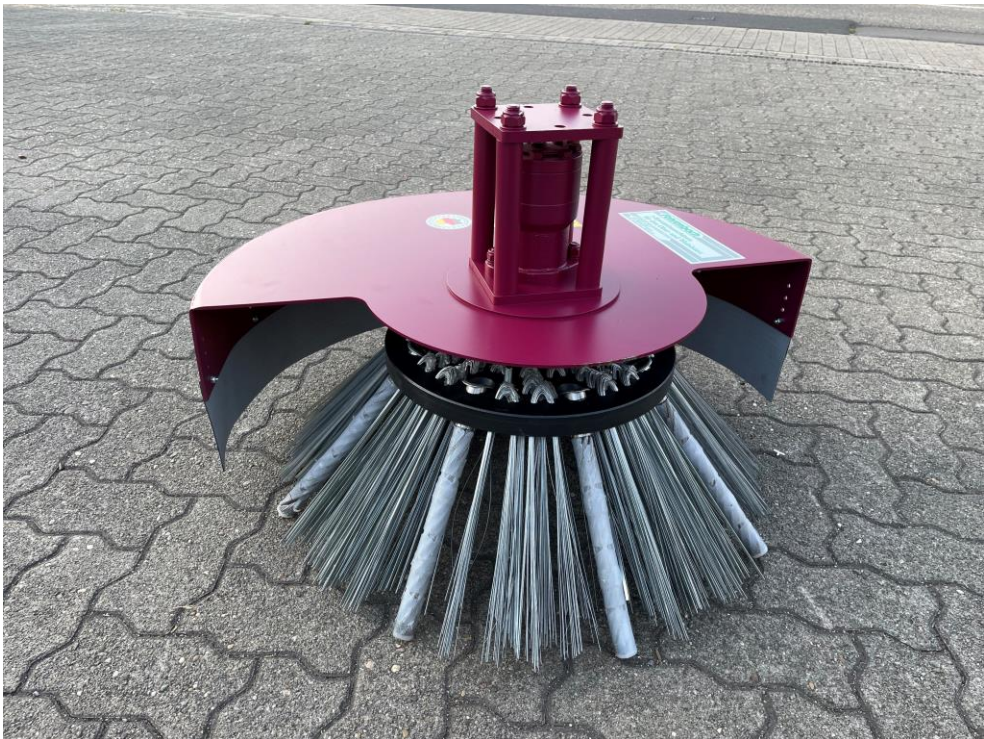
Pos. 10 Wildkrauttellerbesen mit 8 Wildkrautbüschel Ø 20 mm und Stahlfäden
